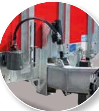
Zugrohr-Höhenverstellung stufenlos Mit hydraulischer Betätigung
