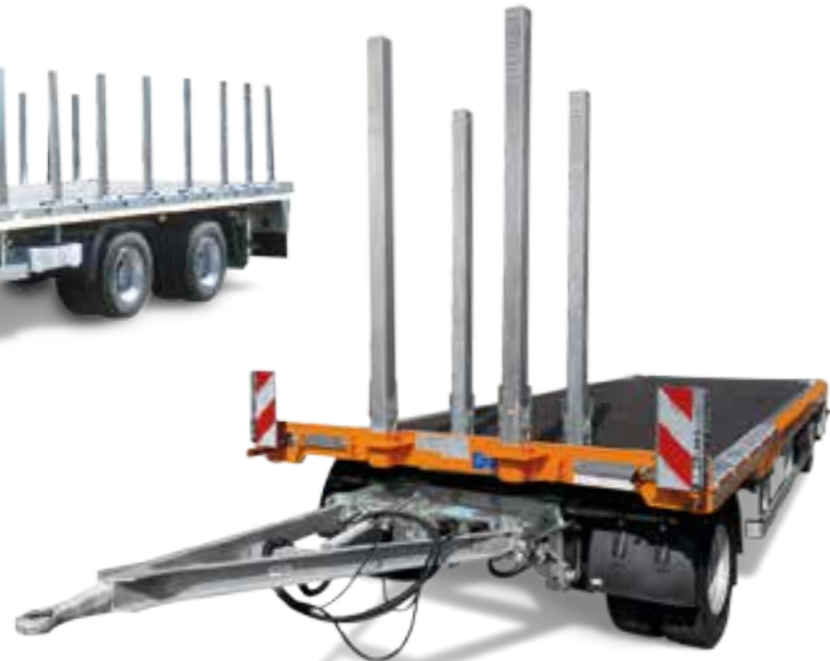
Jumbo-Rahmen, niedrigste Ladehöhe (Stahlplatte über Drehgestell)
