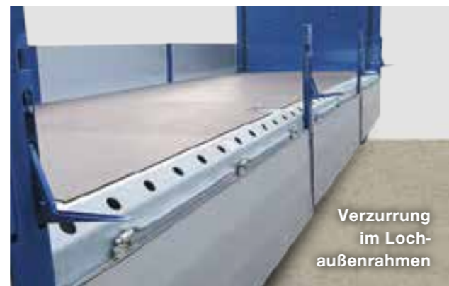
Jumbo-Rahmen, niedrigste Ladehöhe (Stahlplatte über Drehgestell)
