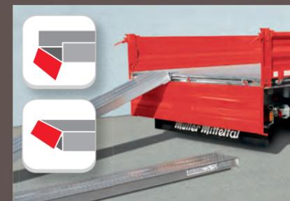
**Neu ist die optionale Kombitüre.** Die zweiflügelige Rückwandtür ist einfach bedienbar und lässt sich nach dem Öffnen seitlich fixieren. Großvolumige Ladung wie z.B. Sträucher lassen sich problemlos abkippen. Die Alu-Rampen können beim Entnehmen aus dem Schacht direkt ohne Ablegen auf dem Boden angelegt werden. Für rieselfähiges Schüttgut kommt die Pendelfunktion mit der automatischen Rückwandöffnung zum Einsatz.
