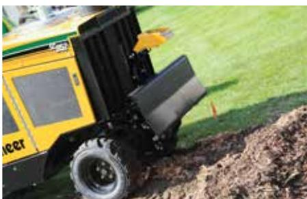
**SPANBESEITIGUNG MIT RÄUMSCHILD.** Die große Bodenfreiheit und das an den Kanten abgerundete Räumschild ermöglichen eine gute Spanbeseitigung, sodass die manuelle Arbeit reduziert wird. Der breite Radstand verleiht der Maschine Standfestigkeit.
