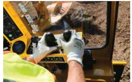
**BEDIENERSICHERHEITSSYSTEM (TOTMANNSCHALTUNG).** Dieses benutzerfreundliche Sicherheitssystem schützt den Bediener und erhöht die Sicherheit. Sobald die Hände des Bedieners die Steuerhebel länger als eine Sekunde verlassen, stoppt das Fräsrads und die Kontrollleuchte erlischt.
