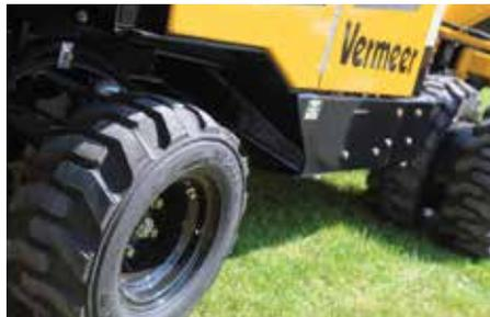
**FÜR JEDES GELÄNDE.** Durch den Allradantrieb ist es der SC852 möglich unebenes Terrain problemlos zu überqueren. Die zusätzliche Differentialsperre hält die Traktion der Maschine auch bei schwierigsten Geländebedingungen.
