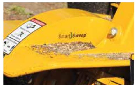
**PATENTIERTES SMARTSWEEP®SYSTEM.** Das exklusive SmartSweep™ System reguliert die Motordrehzahl und Fräsgeschwindigkeit während des Betriebs für ein ruhiges und gleichmäßiges Arbeiten des Fräsrades.
