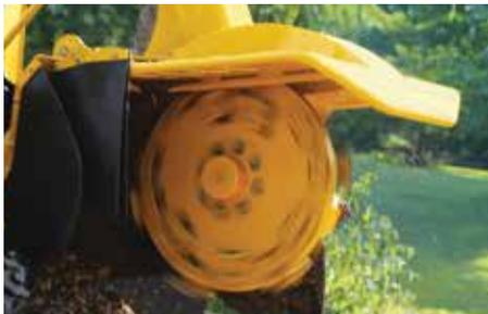
**MAXIMALE FRÄSBREITE.** Die SC852 bietet einen Fräsbereich über Planum von 78,7 cm sowie einen Fräsbereich unter Planum von 63,5 cm. Mit Ihrem Schwenkradius von 182,9 cm ist es möglich größere Baumstümpfe zu fräsen, ohne die Maschine stets neu zu positionieren.
