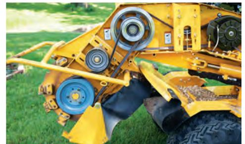
**LEICHTER RIEMENWECHSEL.** Für eine leichte und schnelle Wartung befinden sich alle Riemen auf einer Seite der Maschine. Der Riemenantrieb des Fräsrades wird über bewegliche Umlenkrollen eingestellt. Zusätzlich kann jeder Riemen unabhängig voneinander justiert werden.
