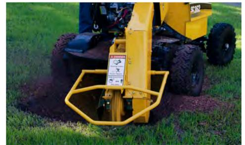
**AUTOSWEEP® SYSTEM.** Mit dem optionalen AutoSweep® System stellt sich die Fräsgeschwindigkeit während des Betriebs automatisch ein, wodurch die Belastung des Motor und Antriebsstrang reduziert wird.
