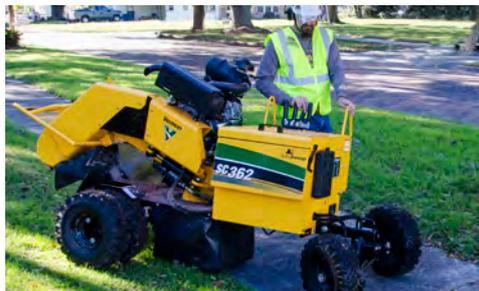
**ZWEIGANG-FAHRANTRIEB.** Der Bediener kann beim Betrieb zwischen zwei Fahrgeschwindigkeiten wählen. Mit dem höheren Gang (0-40,5 m/min) lässt sich die Maschine schnell zwischen den Baumstümpfen fortbewegen, der niedrige Gang (0-20,1 m/min) ist für das Manövrieren um den Stumpf geeignet.
